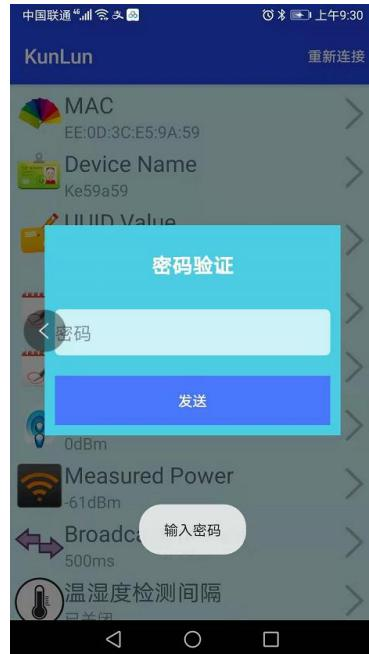
4.9 连接后可以对相关参数进行设置，如：设备名称、UUID、MAJOR、MINOR、发射功率、广播频率、1米处参考功率等。
