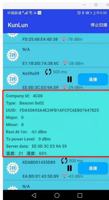
4.8 如果有“连接”按钮，说明此蓝牙信标可以被连接，点击连接，要求输入密码，密码为：1234。
