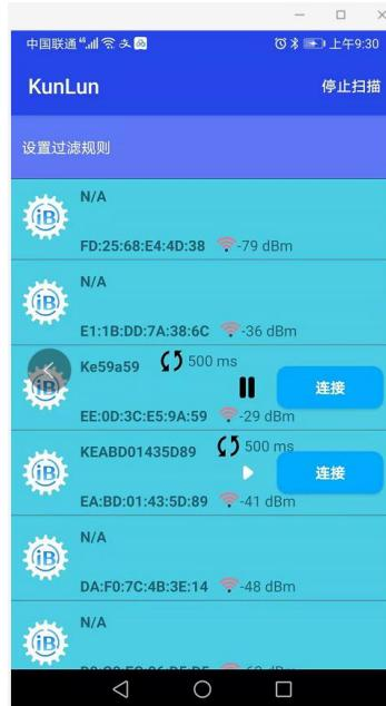
4.7 点击其中一个，可以查看详细信息如下图，如果蓝牙信标带温湿度传感器，则会显示温湿度，如果蓝牙信标带加速度传感器，则信标静止时蓝牙名称后面有“暂停”符号，信标运动时蓝牙名称后面有“播放”符号。
