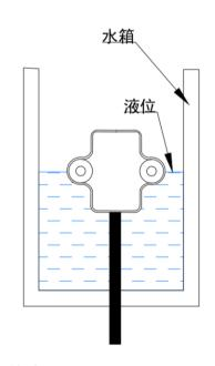
粘贴式安装方法如图,可以直接粘贴于塑胶容器外壁。
