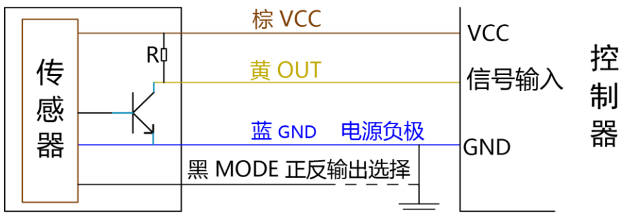
高低电平信号输出：连接控制器或MCU的接线方法
