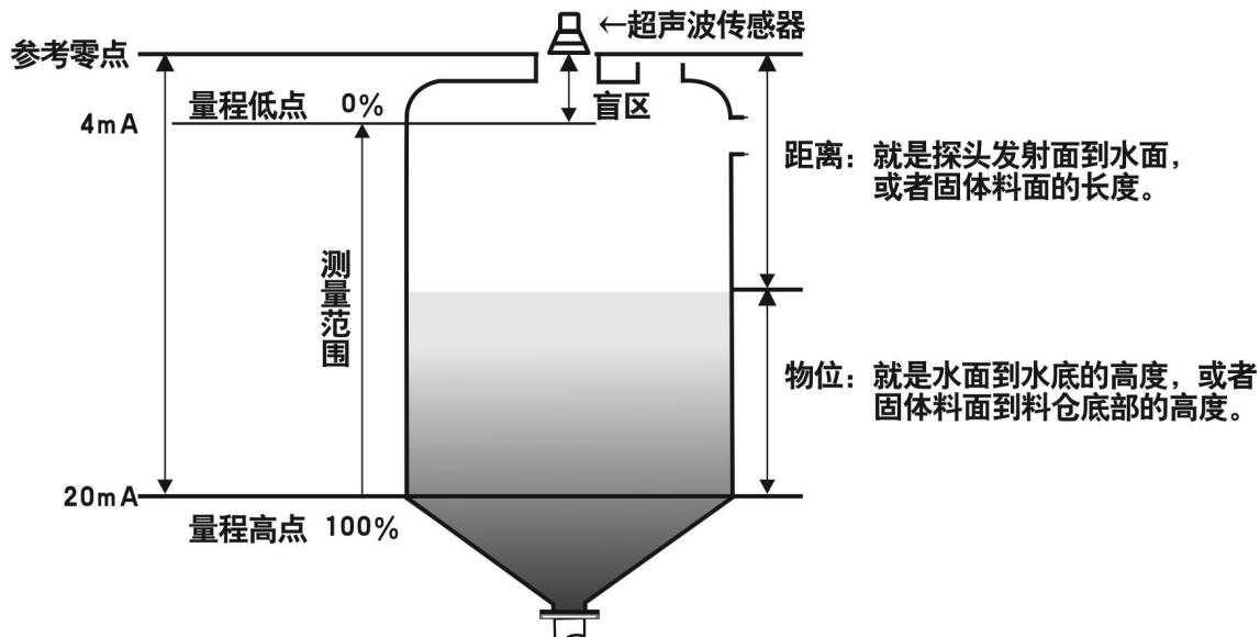
物位测量模式下，参考零点、量程高点、量程低点的位置参见下图。
