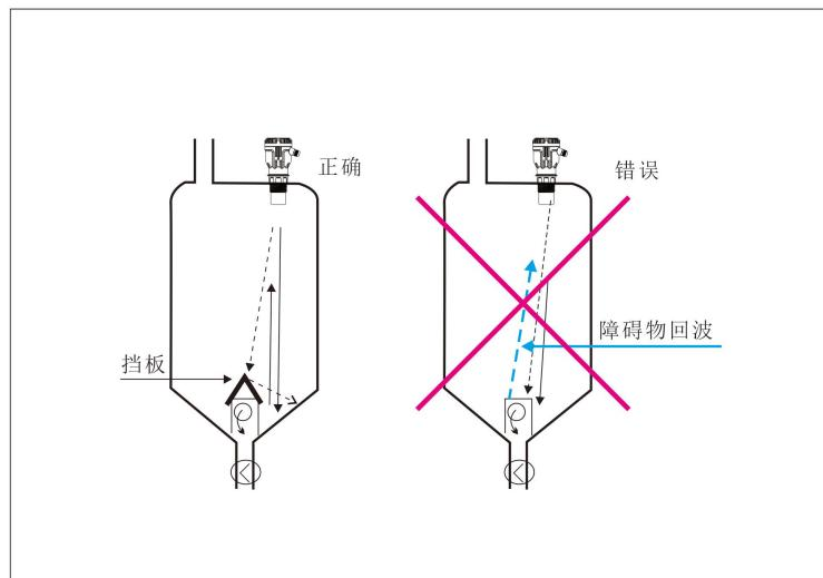
容器内的装置，比如：管子、支架都会对测量造成影响。在测量点设计上，必须注意超声波信号的扩散范围内不能有其他装置。
