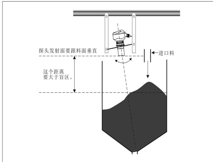
在露天料堆安装时，大的露天料堆需要通过多个仪表进行测量，仪表可以固定在起重架上，传感器探头应该对准介质表面。
