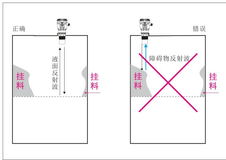
在蓄水池内，一般来说要根据最高水位来决定仪表的安装高度，必须注意到最高水位到探头之间的距离，低水位的时候露出的池底有落差物体的，这个边缘要用折射板挡上。
