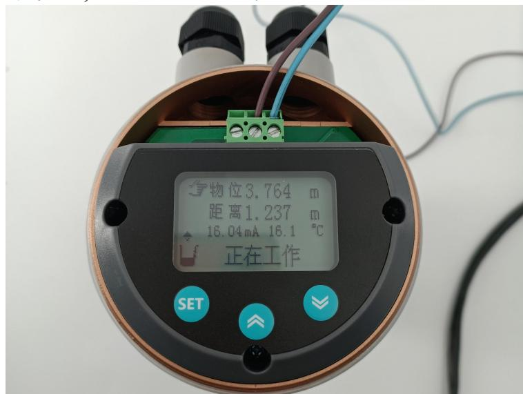
面板上有三个按键，通过这三个按键可对仪表进行调试。调试后液晶屏幕上显示测量值。
