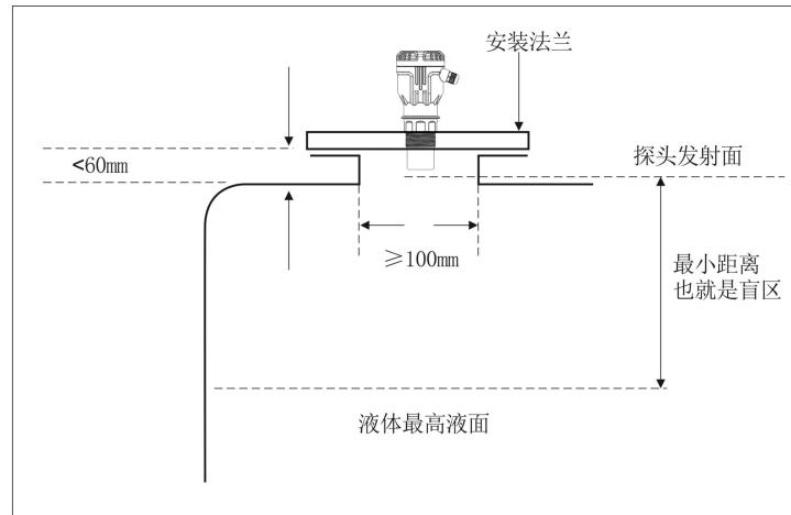
最理想的安装是直接将仪表安装在平顶容器上，不使用接管，容器上的圆形开口就可以足够固定安装用的法兰或者万向节。探头发射面是在基准面以下。
