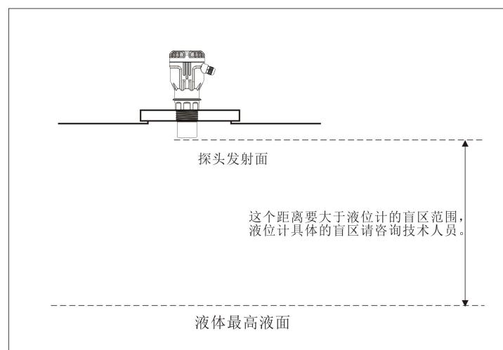
安装在跟探头一样的螺纹接管上，在这种情况下，接管的内径大小跟探头的外螺纹几乎一样，探头的发射面必须伸出接管 1cm 以上，不能缩在接管内。
