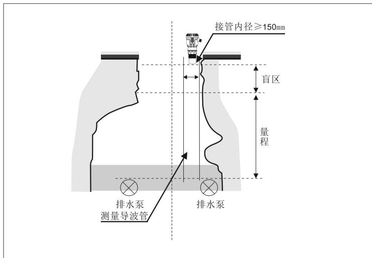
普通水井(包括水源井、深水井)，一般直径都不大，导波管可以使用整根的 PVC，PR，PP 等内壁平整的塑料管道，也可以使用 304、316 等内壁平整的不锈钢管道。
