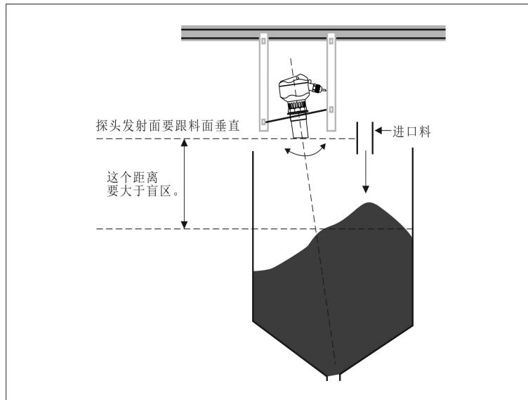
在露天料堆安装时，大的露天料堆需要通过多个仪表进行测量，仪表可以固定在起重架上，传感器探头应该对准介质表面。
