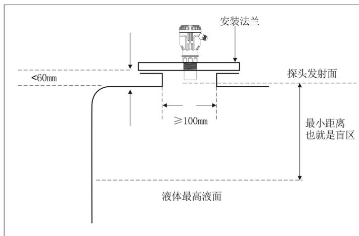
最理想的安装是直接将仪表安装在平顶容器上，不使用接管，容器上的圆形开口就可以足够固定安装用的法兰或者万向节。探头发射面是在基准面以下。
