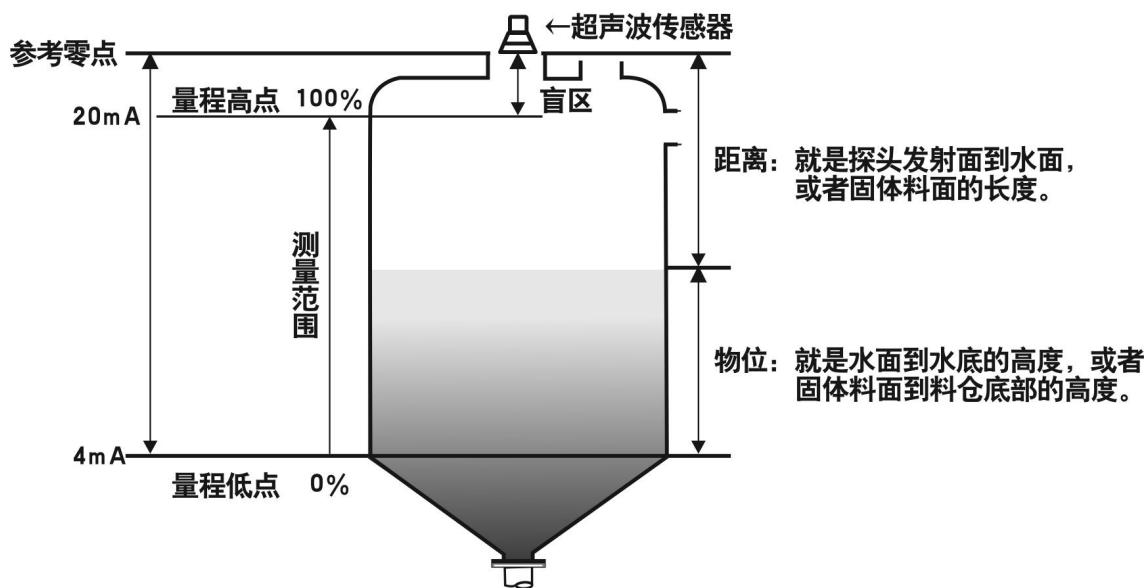
**量程低点：**参考平面到该位置的距离值。当量程低点高于参考平面时数值为正，低于参考平面时数值为负。液位在该位置时输出 4mA 电流。
