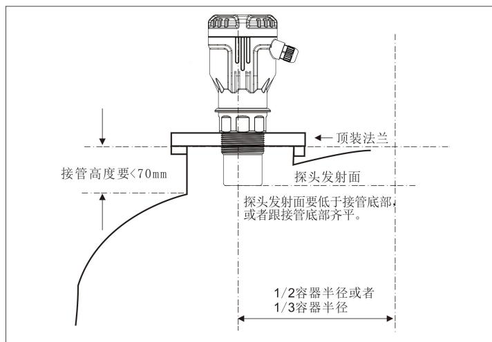
在大多数的拱形罐顶上，接管加上法兰的长度有150-180mm长度，而超声波物位计的探头螺纹以下都没有这么长的(可以定制加长型探头，以使探头发射面低于接管底部)。在这样的情况下，我们需要注意接管直径和接管长度的比例关系。
