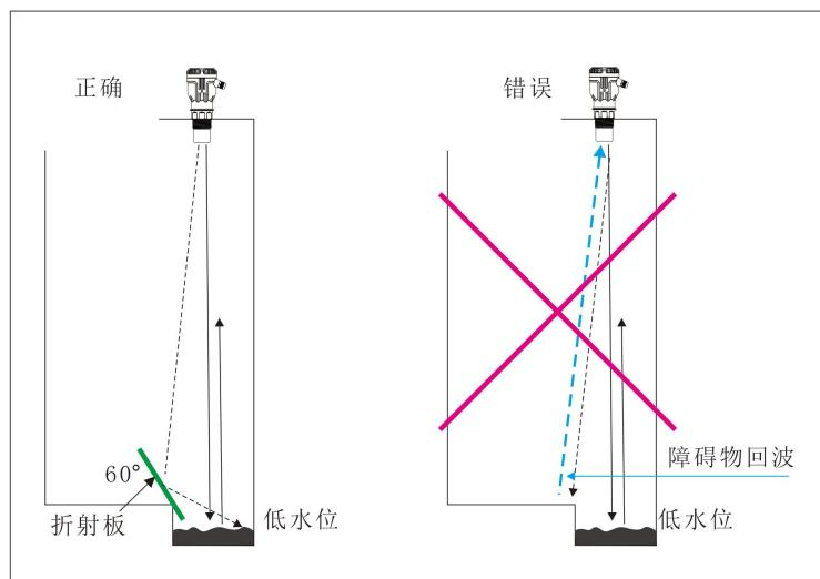
如果容器内有很强的涡流、漩涡，比如：由搅拌器、强烈化学反应造成的涡流，测量就会很困难。理想的方式是：传感器探头可以安装在导波管或者旁通管中测量。
