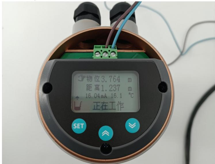
面板上有三个按键，通过这三个按键可对仪表进行调试。调试后液晶屏幕上显示测量值。
