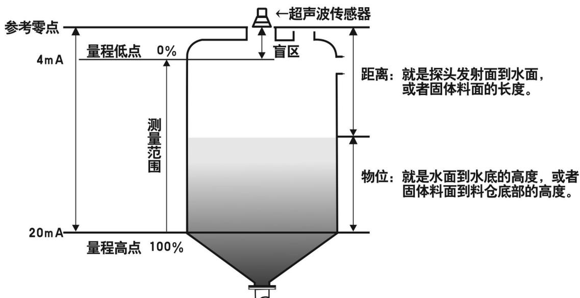
物位测量模式下，参考零点、量程高点、量程低点的位置参见下图。
