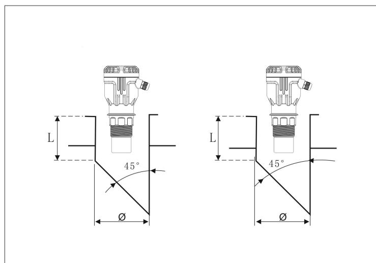
延长接管如果是从罐顶一直通到罐底安装的情况下，接管内径跟传感器测量距离的关系请看下表。
