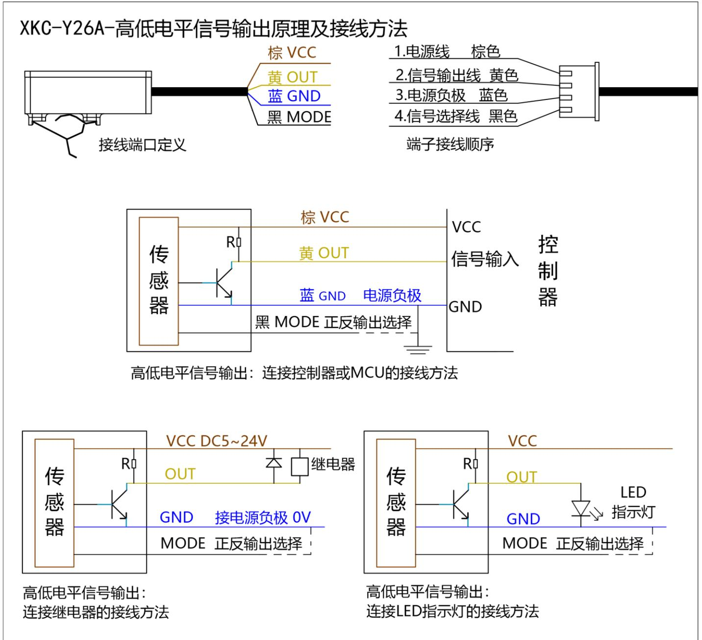
高低电平输出驱动小型继电器(线圈电流 $\leq 100\text{mA}$ )工作原理:
