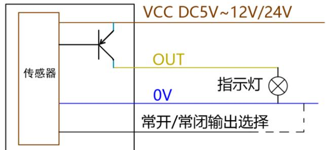
PNP 输出驱动小型继电器(线圈电流 $\leq 100\text{mA}$ )工作原理:
