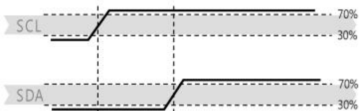
图19 停止传输状态（P）-当SCL高电平时，SDA线上从低电平转换为高电平。停止状态是由主机控制的一种特殊的总线状态，指示从机传输结束（Stop之后，BUS总线一般被认为处于闲置状态）。
