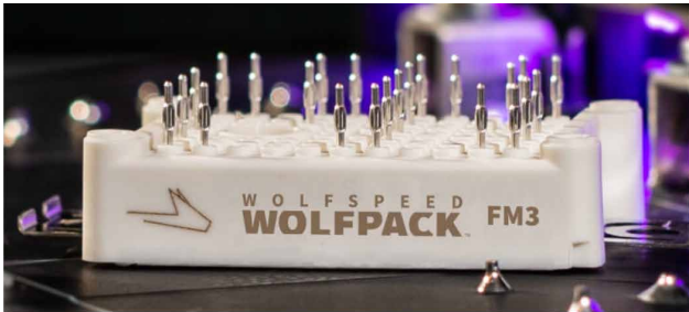
图 1. Wolfspeed WolfPACK FM3 功率模块及引脚网格设计实例，实现了扩展能力和灵活性。图片由 Wolfspeed 提供，获准重新印刷。
