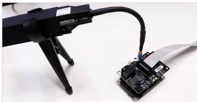
图 15. 方针式传感器尖端电缆。图片由 Wolfspeed 提供，获准重新印刷。
