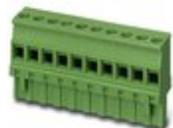
插拔式连接器，额定横截面: 2.5 mm<sup>2</sup>，颜色: 绿色，标称工作电流: 12 A，额定电压(III/2): 320 V，触点表面: 锡，触点类型: 孔式连接器，电位数: 8，行数: 1，每行位数: 8，连接量: 8，产品系列: MVSTBR 2,5/..-ST，针距: 5 mm，接线方式: 带压片的螺钉连接，螺钉头规格: L 开槽，导线 / PCB连接方向: 90°，锁扣: - 锁扣，插拔系统: CLASSIC COMBICON，锁紧装置: 不带，安装: 不带，包装类型: 纸箱包装
