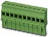
插拔式连接器, 额定横截面: 2.5 mm<sup>2</sup>, 颜色: 绿色, 标称工作电流: 12 A, 额定电压(III/2): 320 V, 触点表面: 锡, 触点类型: 孔式连接器, 电位数: 15, 行数: 1, 每行位数: 15, 连接量: 15, 产品系列: MVSTBR 2,5/..-ST, 针距: 5.08 mm, 接线方式: 带压片的螺钉连接, 螺钉头规格: L 开槽, 导线 / PCB连接方向: 90°, 锁扣: - 锁扣, 插拔系统: CLASSIC COMBICON, 锁紧装置: 不带, 安装: 不带, 包装类型: 纸箱包装
