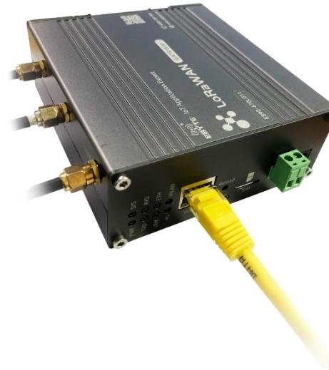
如上图所示，将 WIFI 天线，LoRa 天线，分别接在设备面板标识下的 SMA 接口上，在设备加电之前（加电位置在面板处已有标识）。上述完成步骤后，使用设备配套的电源，然后给网关上电。将计算机与设备的 WIFI 相连接(WIFI 名字为 E890-XXXX)，设备 WAN 口接以太网。
