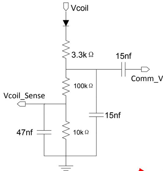
图 4 电压 ASK 解调外围电路
