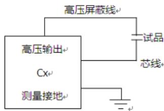
注：（小图）仪器面板简图只标了“高压屏蔽线”，现实操作时也可以如大图所示，高压芯线与高压屏蔽线可以夹在一起测试
