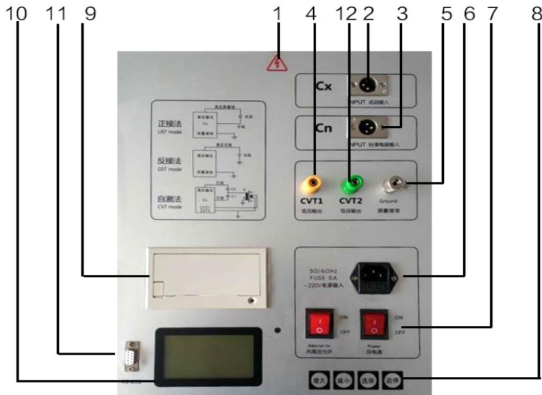
1 高压输出端 2、CX 试品输入 3、CN 标准电容输入 4 CVT1 5、测量接地 6、电源输入
