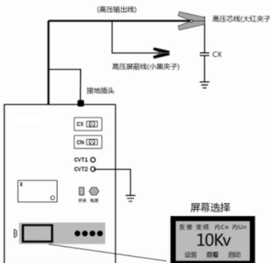
用高压线芯线（红夹子）连接试品高压端。
