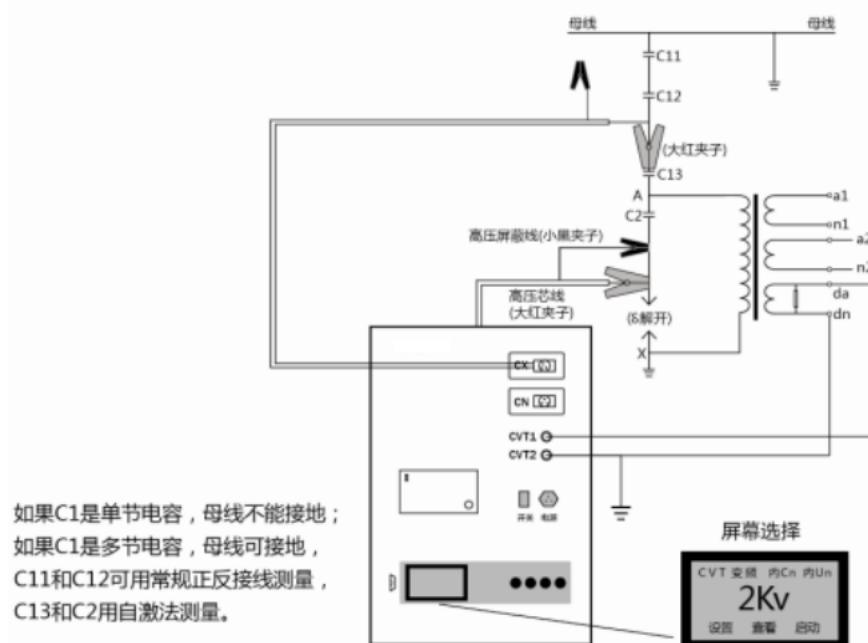
高压芯线接  $C_2$  末端 J, Cx 芯线接  $C_{12}$  上端。不要 Cx 接  $C_2$ 、高压线接  $C_{12}$ , 这样做的数据误差较大。
