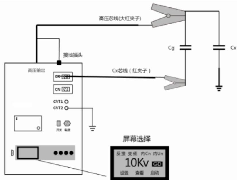
光标在“反接”位置按“启停”键，屏幕右侧显示 **GD**，启动反接线低压屏蔽功能。再次按“启停”键，恢复正常反接线。需要屏蔽的电容 C<sub>g</sub> 的低压端子不能承受高电压，不能用常规反接线的 10kV 高压屏蔽，因此只能使用反接线低压屏蔽。
