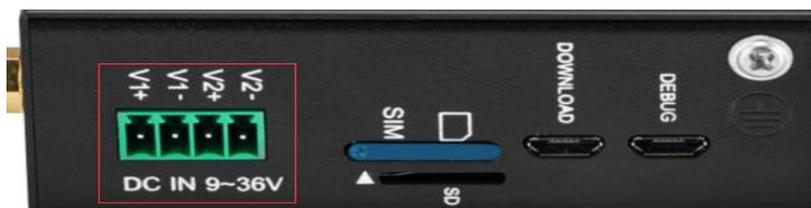
网关提供两路可选输入端口，支持 9~36V DC 输入，支持反接防护。
