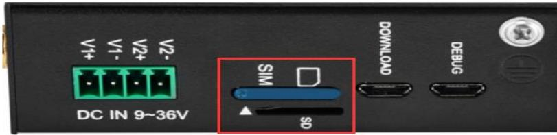
插入/移除 SIM 卡时，先确保设备已关机，用取卡针插入卡槽小孔，稍微用力按下将卡槽顶出来。
