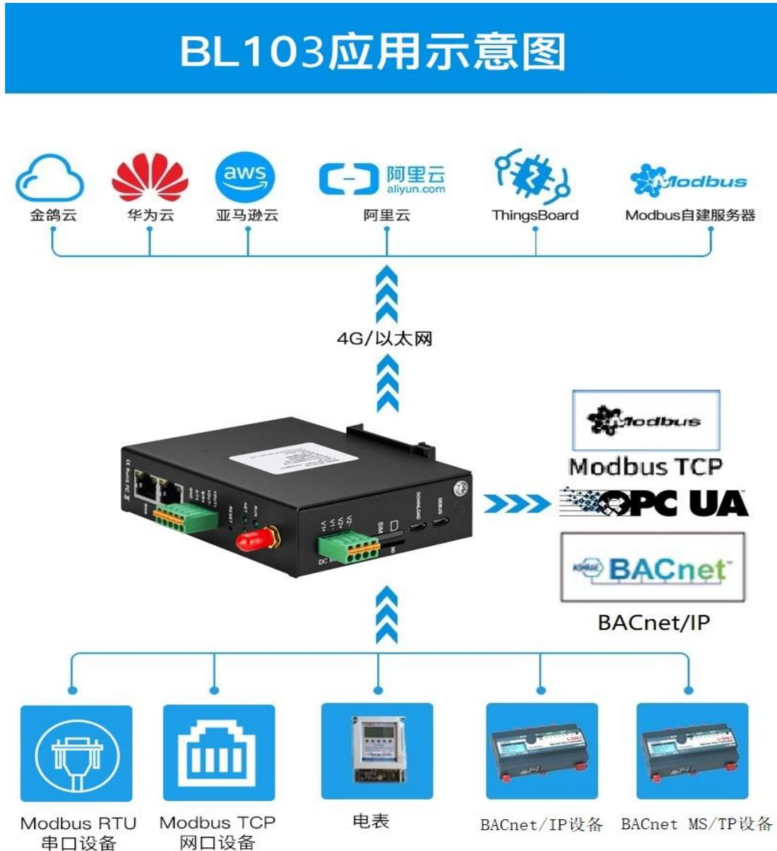
注：BL101 应用示意图是 BL103 应用示意图下行不能采集 BACnet 设备，上行没有 BACnet/IP 协议。
