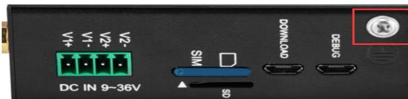
网关接地线有助于防止电磁干扰带来的影响。在连接设备之前，先通过接地螺丝接线让设备接地。
