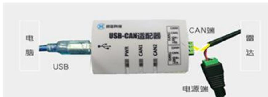
图 4.5 电源&CAN 盒子连接示意图
