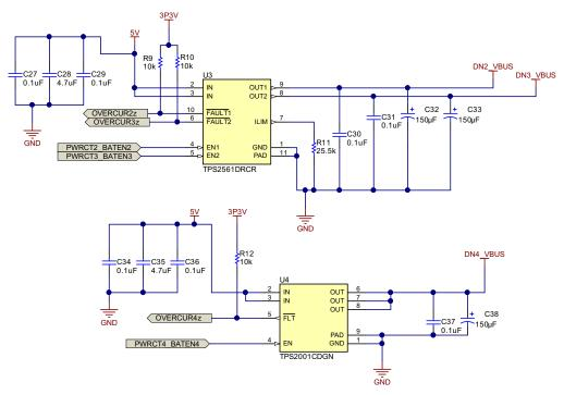
图 42. VBUS Power Switch Implementation
