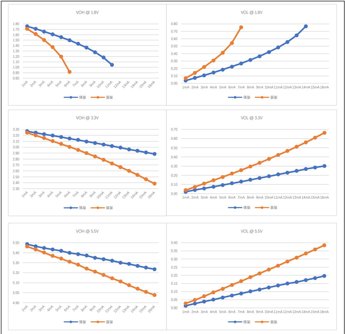
图 7-2 输出端口 VOH/VOL 实测曲线
