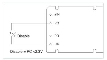
Figure 2 — Module enable/disable
