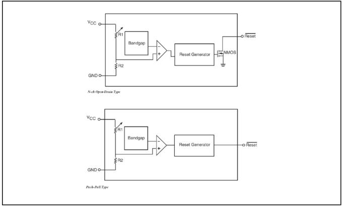
Fig. 2: SP809N/SP809 Block Diagram
