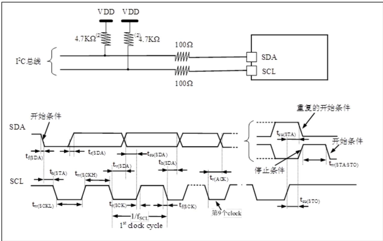
1. 测量点设置于CMOS电平：0.3V<sub>DD</sub>和0.7V<sub>DD</sub>。
