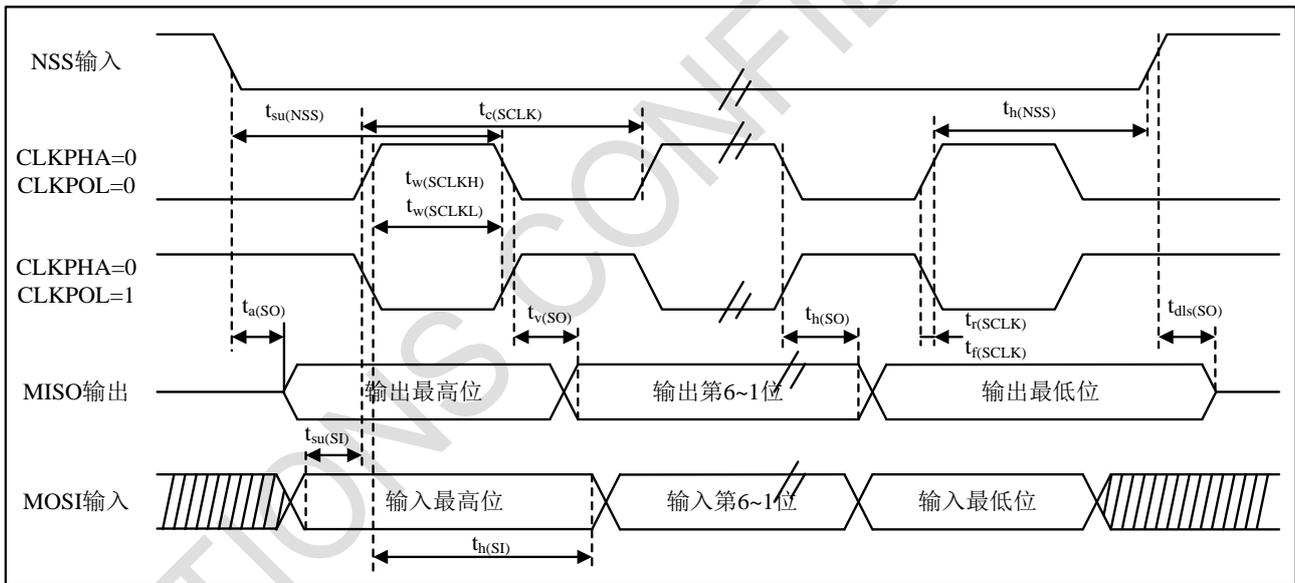
图4-13 SPI时序图 – 从模式和CPHA=1<sup>(1)</sup>
