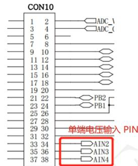
图 6 AIN2 AIN3 在原理图上的位置
