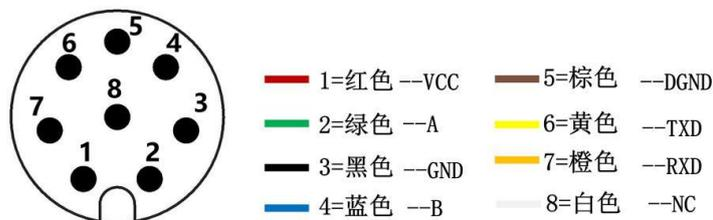
图 4.3 八芯电缆颜色定义
