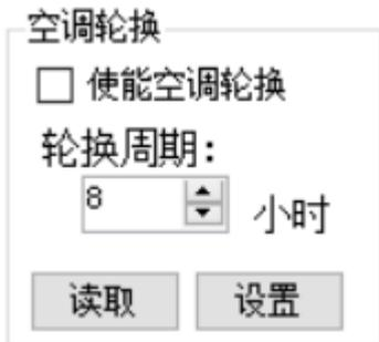
同时如果需要进行两台空调进行轮换工作，可以设定空调轮换功能，保证两台空调均衡工作，延长空调寿命。
