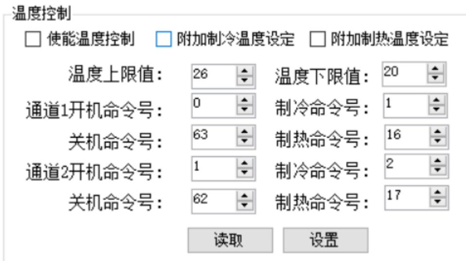
本司空调遥控器的温度控制，有两种方式：温度上下限控制和恒温控制。
