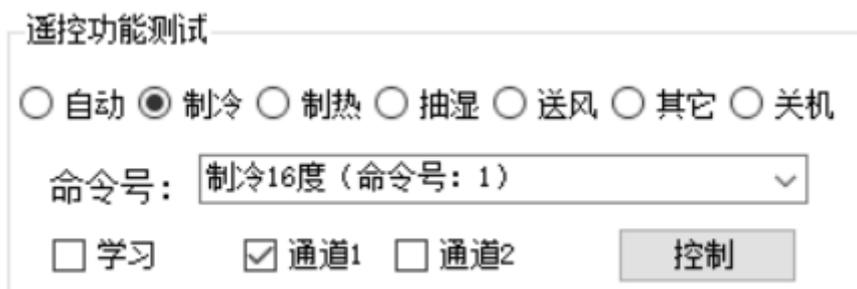
对空调遥控器功能自学习完成后，安装好遥控发射头（一般距离空调5米以内，发射头正对空调的红外接收窗口），即可使用本智能遥控器的RS485接口发送命令进行测试，选择遥控命令号后，点击发送，观察空调控制情况。
