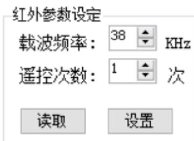
对红外空调遥控器载波频率基本上都是标准的38KHZ，选择默认设置即可。遥控次数是RS485口接收控制命令后，给空调发送相同命令的次数，一般设定为1即可，如果有外界干扰时，为提高控制成功率，可设定每次发射多次。
