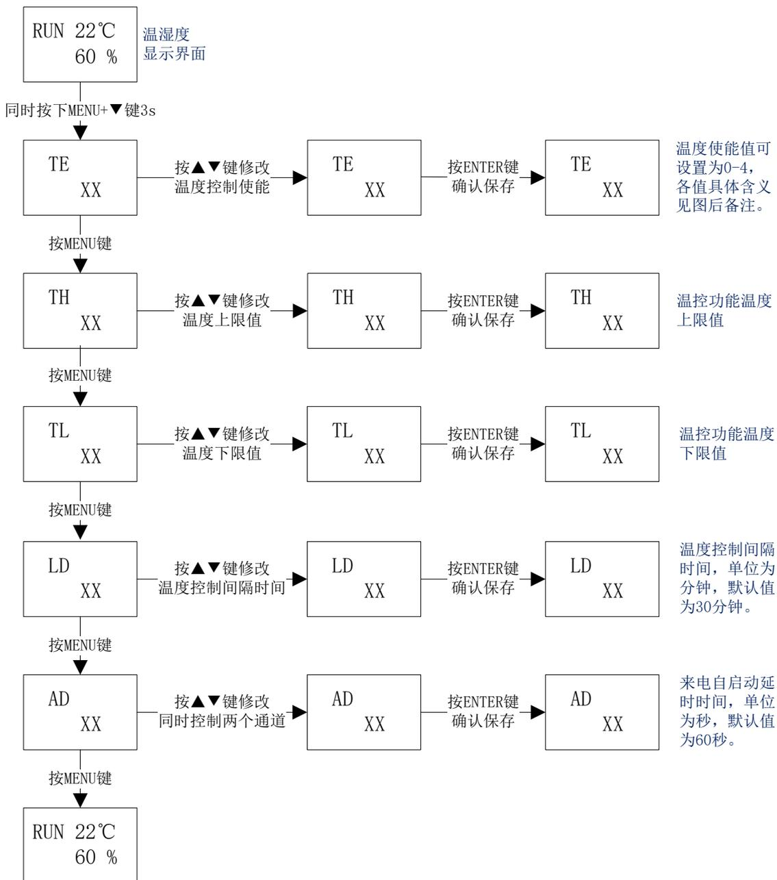
备注：(1)温度控制TE值设置为0，表示不使能温度控制功能；设置为1，表示使能温度上下限控制模式；设置为2-4值时，表示设置为恒温控制模式。
