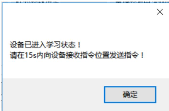
工具会弹出提示框，此时控制器屏幕上方有一个插头提示符号，表明设备进入到学习模式；然后将原厂遥控器对着红外接收感应位置，发送需要学习的指令，学习成功后，控制器会自动保存指令并在控制器屏幕上方有一个铃铛符号提示学习成功。
