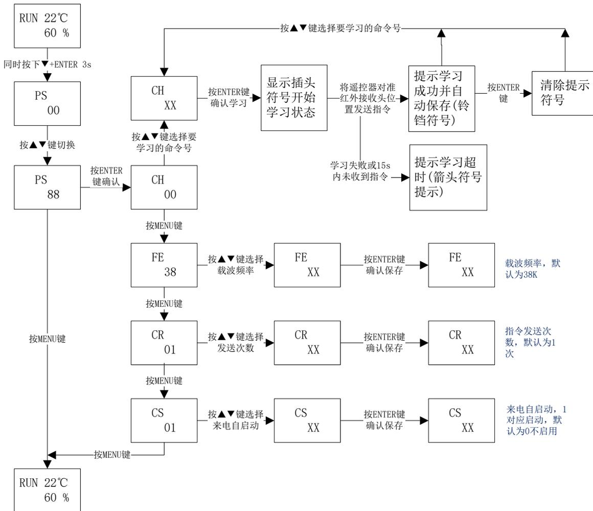
备注：关于来电自启动CS的值的说明：设置为0，表示通道一和通道二均不使能来电自启动；设置为1表示只使能通道一来电自启动，不使能通道二；设置为2表示只使能通道二来电自启动，不使能通道一；设置为3表示同时使能通道一和通道二的来电自启动功能。
