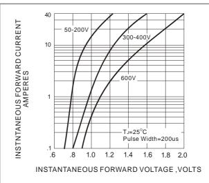
Fig.4- TYPICAL INSTANTANEOUS FORWARD CHARACTERISTIC
