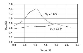
Figure 20. Ron vs V<sub>COM</sub>
