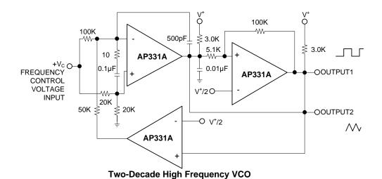
$V^* = +30 V_{DC} \\ +250 m V_{DC} \le V_{C} \le +50 V_{DC} \\ 700 Hz \le f_{O} \le 100 KHz$   $V^{+} \\ V_{IN} \\ O$   $+V_{IN} \\ O$   $AP331A \\ O$   $V_{O}$
