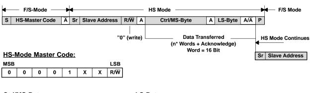
Ctrl/MS-Byte: LS-Byte: **MSB** LSB MSB LSB 0 0 PD1 PD0 D7 D6 D5 D4 D3 D2 D1 D0 Χ Χ X Χ
