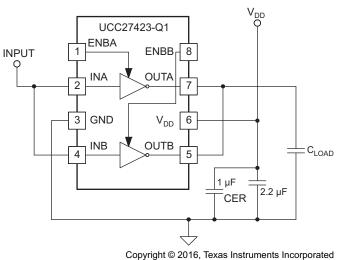
Figure 28. Parallel Outputs
