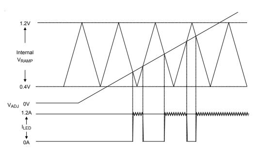
Figure 1. PWM Soft-Start Behavior Mechanism
