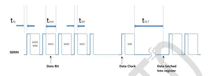
配置数据通过串行输入 "SERIN"设置。外部微控制器 在 SERIN 引脚上生成一个上升沿,随后电平表示配置数据的比特值,由 SERIN 引脚 设置为 0 或 1,数据位的时间大于 72μS. 当设备已经接收到超过 25bits 数据时,超过 580μS 以上传送被中断,接收到的 LSB 被锁存到所述配置寄存器。25 位数据字的传输不能超过 350μS 以上,由于设备可能在这个阶段锁定已经存在的数据。用 DOCI/INT 引脚读回传感器的配置数据。
