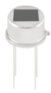
**XYC-PIR214D-D0** 数字热释电红外传感器是将传统热释电红外传感器的敏感元与信号处理芯片集成化设计,将敏感元与 IC 芯片集成封装到传感器屏蔽罩内部,敏感元通过感应外界人体移动产生的红外信号,以差分输入的方式传送到高精度的数字智能处理芯片进行处理,可配置的运动检测单元中实现。一旦检测到运动,中断将被发送到主机系统。主机系统可以通过休眠方式实现超低功耗。主机系统访问器件,读取数据进行信号分析。
