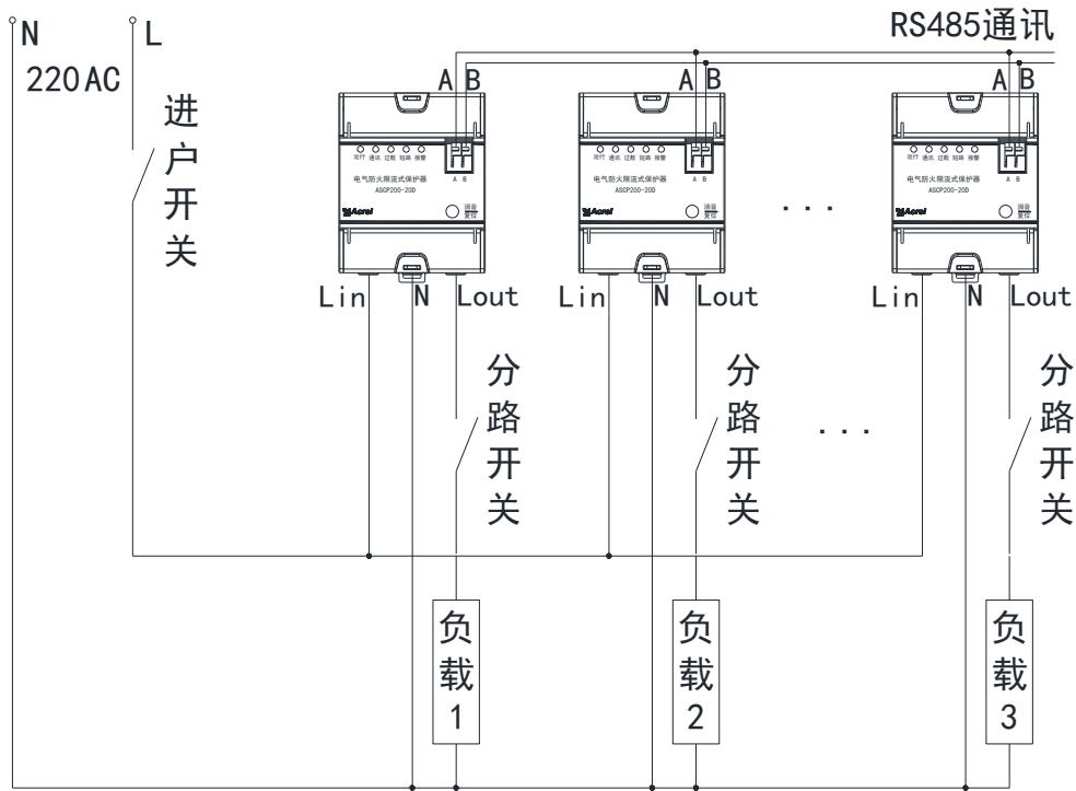
保护器最大额定电流 20A，一般接在进户开关后方，出线接单个负载；也可以单个保护器后方接多个负载（保证负载额定电流不超过 20A）。
