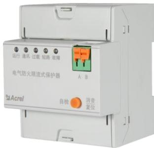
ASCP200-20D 电气防火限流式保护器是安科瑞电气专门为保护低压配电线路中短路、过载等问题研发，单相线路保护，额定电流 20A。可以有效克服传统断路器、空气开关和监控设备存在的短路电流大、切断短路电流时间长、短路时产生的电弧火花大，以及使用寿命短等弊端，发生短路故障时，能以微秒级速度快速限制短路电流以实现灭弧保护，从而能显著减少电气火灾事故，保障使用场所人员和财产的安全。
