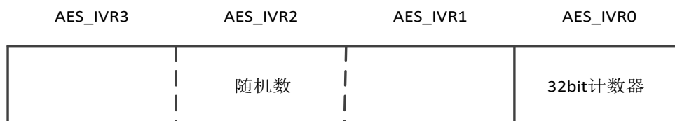
图 16-8 32 位计数器和随机数的存储方式
