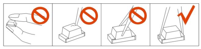
LED 的环氧树脂封装部分相当脆弱,请勿用坚硬、尖锐的物体刮、擦封装树脂部分。在用镊子夹取的时候也应当小心注意。
