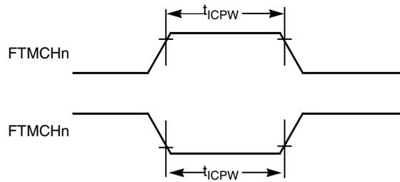
图 12. 定时器输入捕捉脉冲
