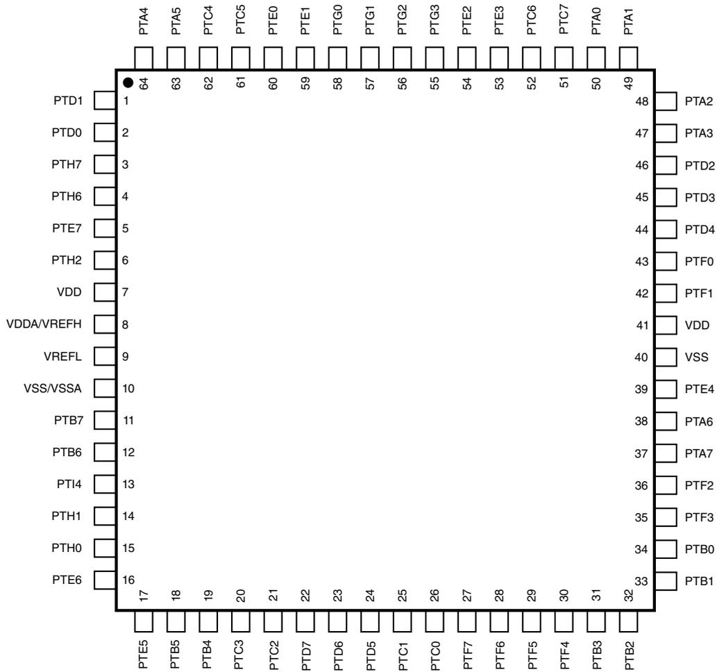
图 22. 64 引脚 QFP/LQFP 封装
