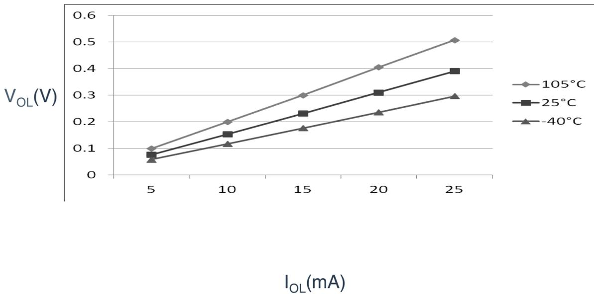
图 7. 典型  $V_{OL}$  对比  $I_{OL}$  (高驱动强度) ( $V_{DD} = 5V$ )
