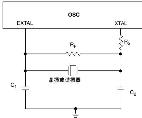
图 15. 典型晶振或谐振器电路
