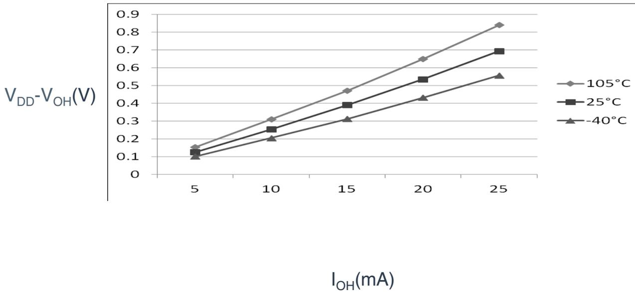
图 4. 典型  $V_{DD}-V_{OH}$  对比  $I_{OH}$  (高驱动强度) ( $V_{DD} = 3V$ )
