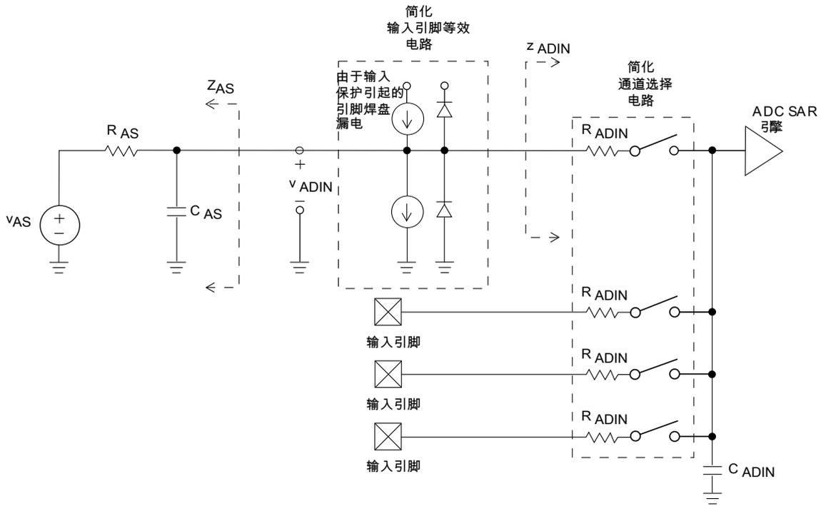
图 16. ADC 输入阻抗等效图
