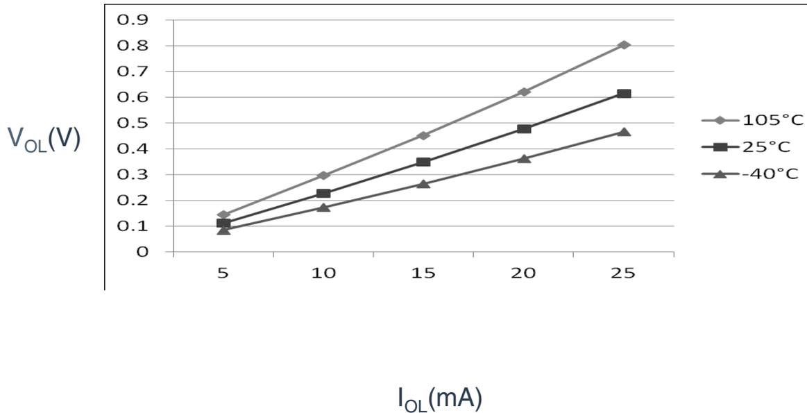
图 8. 典型  $V_{OL}$  对比  $I_{OL}$  (高驱动强度) ( $V_{DD} = 3V$ )
