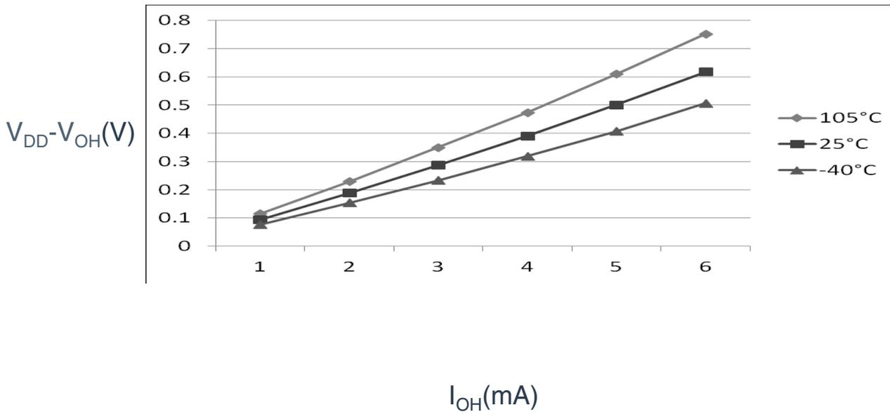
图 2. 典型  $V_{DD}-V_{OH}$  对比  $I_{OH}$  (标准驱动强度) ( $V_{DD} = 5\text{ V}$ )
