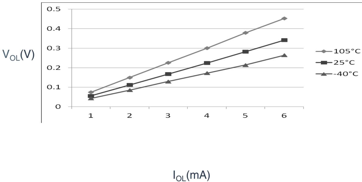
图 5. 典型  $V_{OL}$  对比  $I_{OL}$  (标准驱动强度) ( $V_{DD} = 5V$ )
