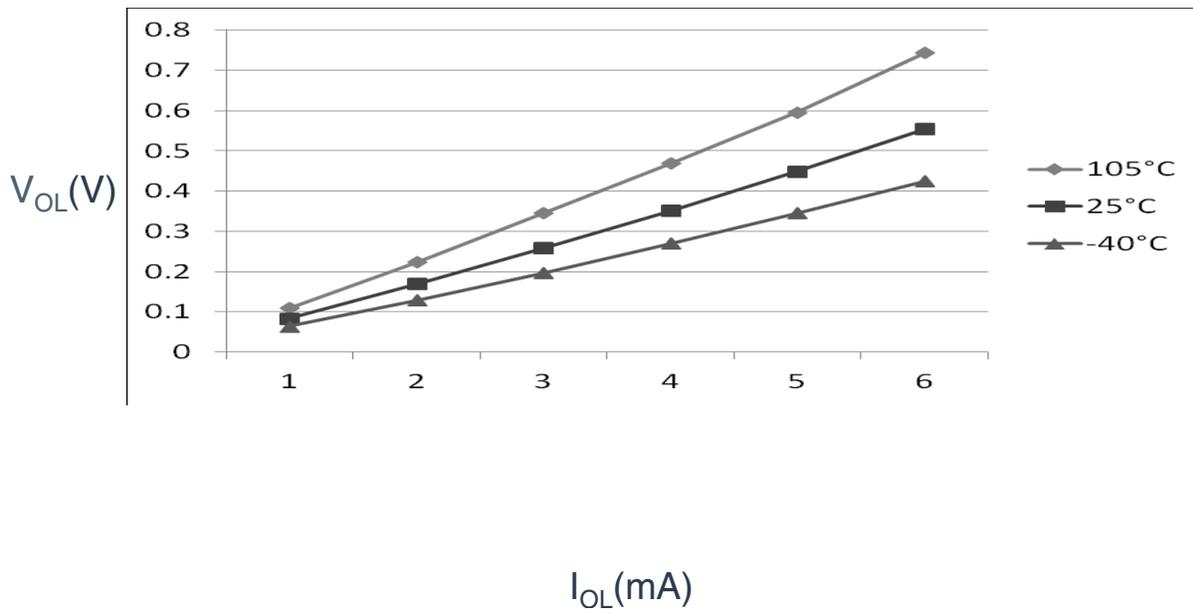
图 6. 典型  $V_{OL}$  对比  $I_{OL}$  (标准驱动强度) ( $V_{DD} = 3V$ )
