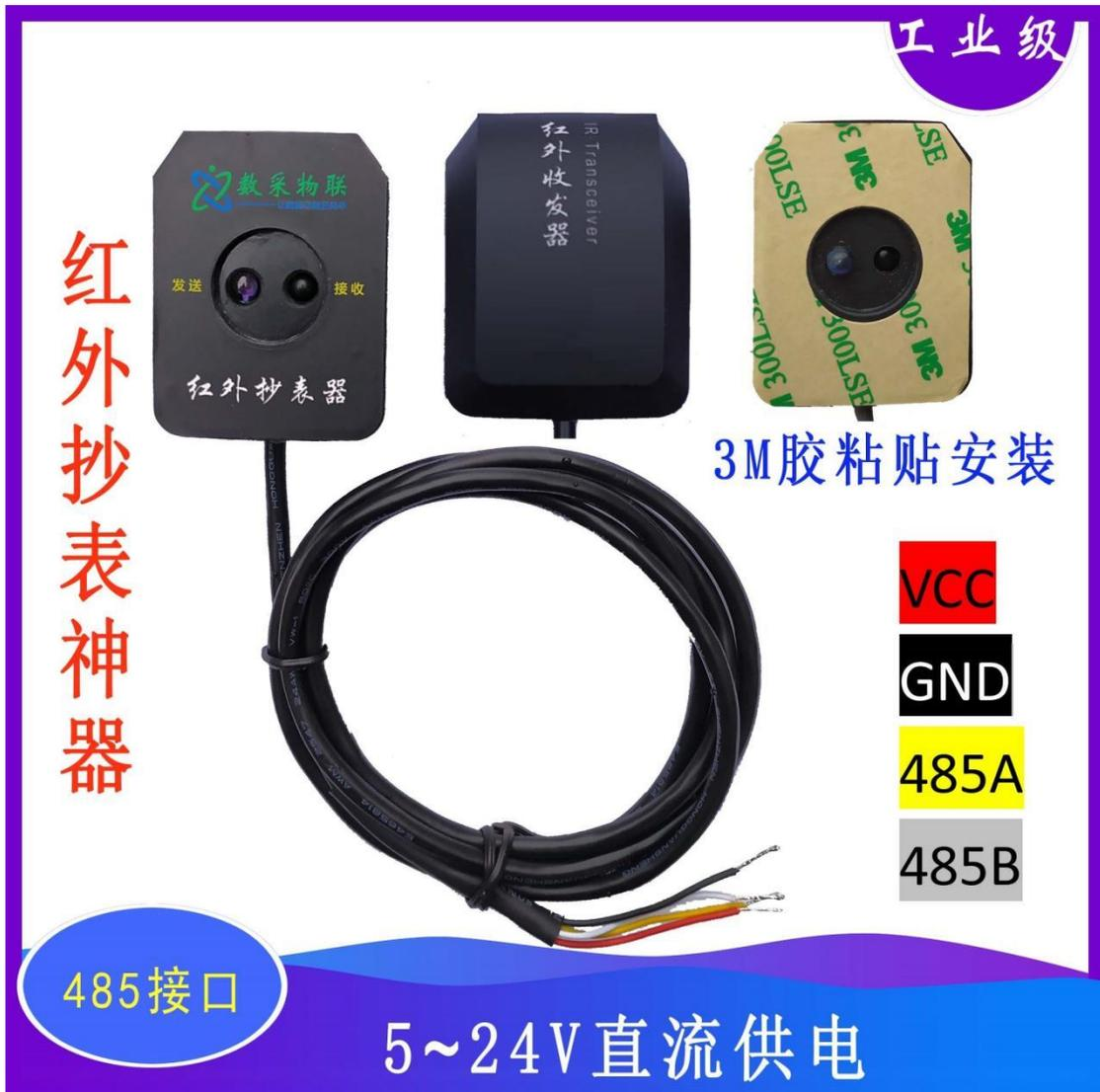
SC-GP-IR485 红外抄表收发器是上海数采物联网科技有限公司推出的一款基于红外通讯，RS485 传输，直流宽电压供电的通用电表燃气表红外抄表光电探头，可采集国网电表的电能数据、电压、电流、功率因数等电参数数据。
