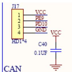
J17 是 CAN 的输出口，配置了 VCC、PE9(CAN\_TX)、PD10(CAN\_RX)、GND。可以配合测试用例验证
