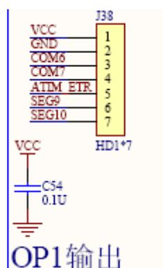
J38 是 OPA1 的输出口，配置了 VCC、GND、COM6(OPA1\_INN2)、COM7(OPA1\_INP2)、ATIM\_ETR(OPA1\_OUT)、SEG9(OPA1\_INN1)、SEG10(OPA1\_INP1)。可以配合测试用例验证
