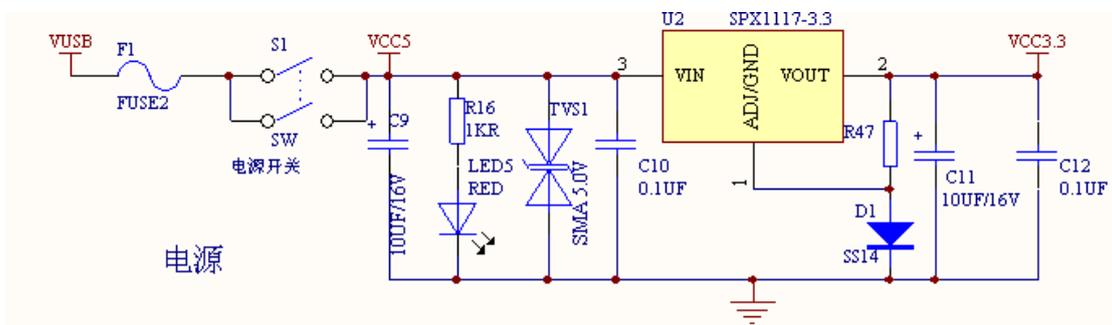
U2 是 SPX117-3.3V 的稳压芯片，LED5 是 5V 电源指示灯，S1 是电源开关，D1 是电压抬升电路，保证 VCC 能达到 3.3V，方便评估测量。
