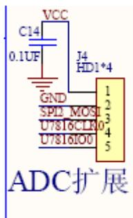
J4 是 ADC 评估扩展口输出，配置了 VCC 、GND、 SPI2\_MOSI(ADC\_IN15)、U7816CLK0(ADC\_IN16)、U7816IO0(ADC\_IN17)三个 ADC 通道，可以配合测试用例验证。
