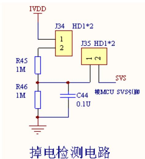
J34 是 SVS 外部电压电源开关，J35 是 SVS 引脚的开关，在 SVS 功能测试时，把 J34、J35 的开关短上。
