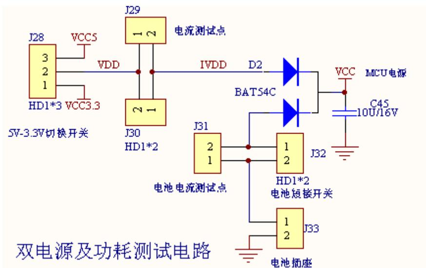
J28 是 5V 和 3.3V 的切换开关，J29 是电流功耗测试点，J30 是电源短接开关，J31 是电池功耗测试点，J32 是电池短接开关，J33 是外部电池接入口。
