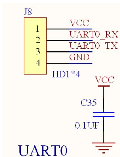
J8 是 UART0 的评估输出口，配置了 VCC、UART0\_RX、UART0\_TX、GND 四个信号，这是低功耗串口，可以配合相应的程序测试用例进行验证。
