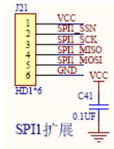
J21 是 SPI1 的评估输出口,配置了 VCC 、SPI1\_SSN、SPI1\_SCK、SPI1\_MISO、SPI1\_MOSI GND 6 个信号,可以配合相应测试用例验证。
