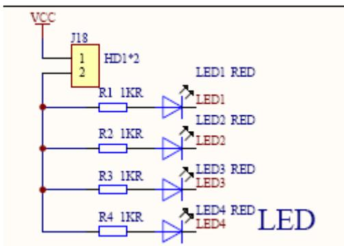
这是支持 4 个 LED 灯，分别对应 LED1-PC1,LED2-PC0,LED3-PD12, LED4-PB15。J18 是 LED 电源的电源控制开关，在低功耗测试时把它断开。
