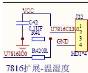
J22 是 7816 的评估输出口,配置了 VCC 、U7816CLK0、 U7816IO0 、GND 四个信号,可以配合测试用例验证。
