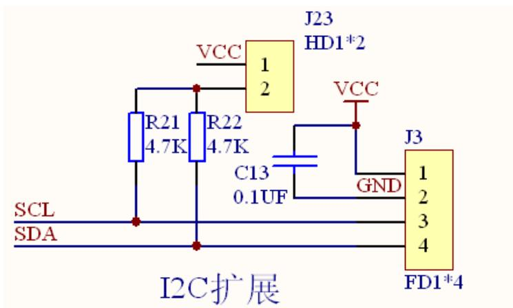
J3 是 I2C 的评估输出口，配置了 VCC、GND、SCL、SDA。J23 是 I2C 的上拉电阻开关，正常工作时把它短接上，在低功耗测试时把短接开关断开。
