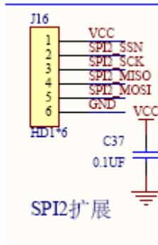
J16 是 SPI2 的评估输出口,配置了 VCC 、SPI2\_SSN、SPI2\_SCK、SPI2\_MISO、SPI2\_MOSI GND 6 个信号,可以配合相应测试用例验证。
