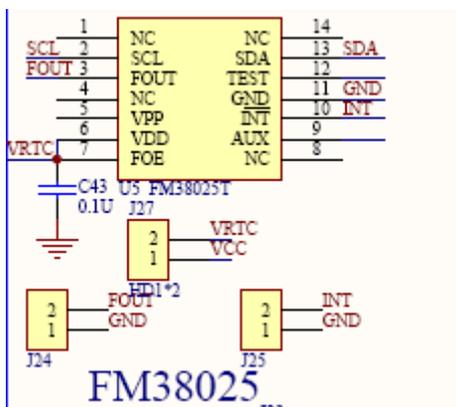
U5 是 FM38025 的内置晶体的高精度 RTC，可以配合相应的测试用例进行功能和功耗测试，J27 可以用来测试功耗。J24 的 FOUT 可以测试秒信号。J25 的 INT 脚可以测试报警中断信号输出。
