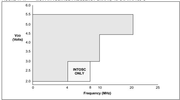
FIGURE 11-2: MAXIMUM OSCILLATOR FREQUENCY TABLE
