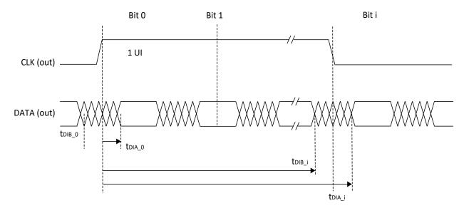
Figure 3.12. Transmitter DDRX71\_TX Waveforms
