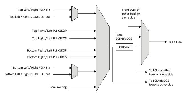
Figure 2.8. Edge Clock Sources per Bank
