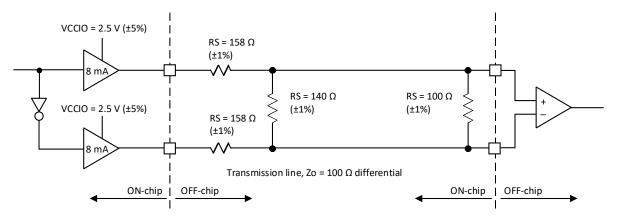
Figure 3.1. LVDS25E Output Termination Example
