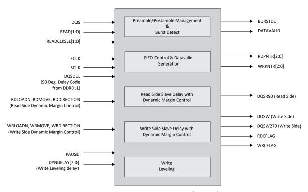
Figure 2.24. DQS Control and Delay Block (DQSBUF)
