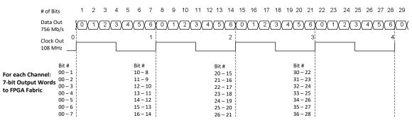
Figure 3.10. DDRX71 Video Timing Waveforms
