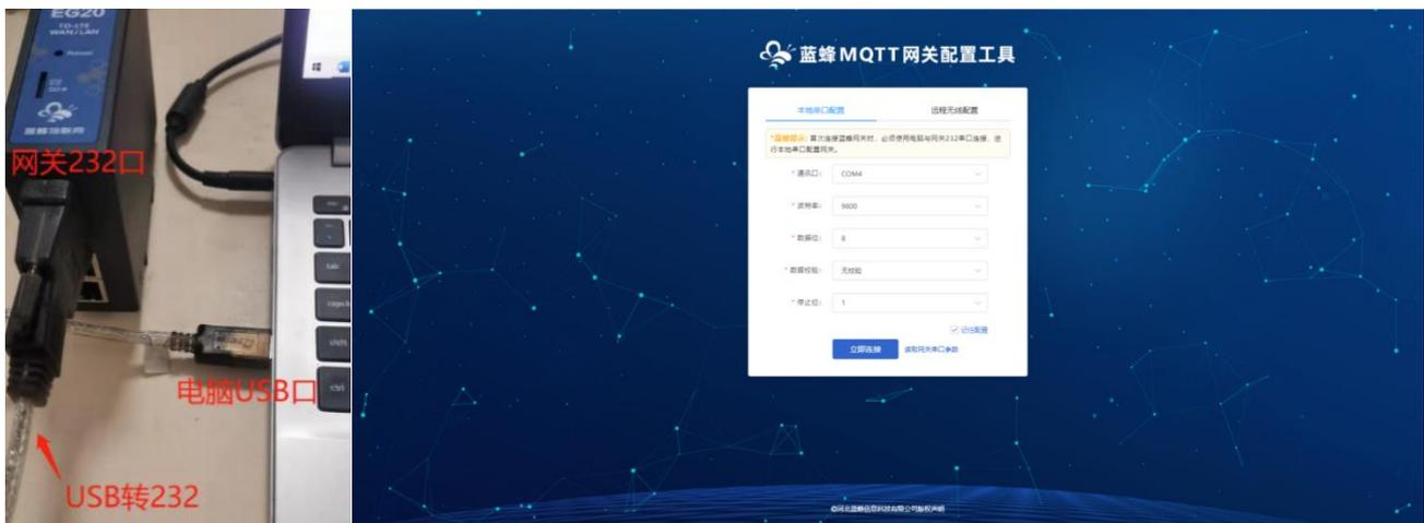
使用 232 串口进行本地配置，将网关的 RS232 口使用 USB 转 232 线接到电脑上，填写配置参数，包括选择通讯口，波特率，数据位，数据校验，停止位。**默认参数为 115200, 8, 无, 1。**
