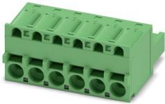
插拔式连接器，额定横截面: 2.5 mm<sup>2</sup>，颜色: 绿色，额定电流: 12 A，额定电压 (III/2): 320 V，触点表面: 锡，触点类型: 孔式连接器，电位数: 6，行数: 1，位数: 6，连接量: 6，产品系列: FKCS 2,5/..-ST，针距: 5.08 mm，接线方式: 直插式弹簧连接，导线/PCB连接方向: 0°，锁扣: - 锁扣，插拔系统: COMBICON MSTB 2,5，互锁: 不带，安装: 不带，包装类型: 纸箱包装
