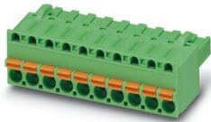
插拔式连接器，额定横截面: 2.5 mm<sup>2</sup>，颜色: 绿色，额定电流: 12 A，额定电压 (III/2): 320 V，触点表面: 锡，触点类型: 孔式连接器，电位数: 6，行数: 1，位数: 6，连接量: 6，产品系列: FKCT 2,5/..-ST，针距: 5.08 mm，接线方式: 直插式弹簧连接，导线/PCB连接方向: 0°，锁扣: - 锁扣，插拔系统: COMBICON MSTB 2,5，互锁: 不带，安装: 不带，包装类型: 纸箱包装
