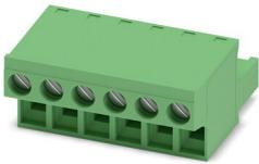
插拔式连接器，额定横截面: 2.5 mm<sup>2</sup>，颜色: 绿色，额定电流: 12 A，额定电压 (III/2): 320 V，触点表面: 锡，触点类型: 孔式连接器，电位数: 6，行数: 1，位数: 6，连接量: 6，产品系列: FRONT-MSTB 2,5/..-ST，针距: 5.08 mm，接线方式: 正面螺钉连接，螺钉头规格: L 开槽，导线/PCB连接方向: 0°，锁扣: - 锁扣，插拔系统: COMBICON MSTB 2,5，互锁: 不带，安装: 不带，包装类型: 纸箱包装
