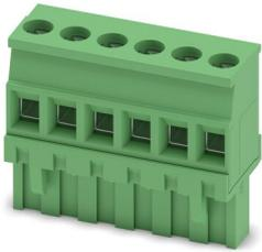
插拔式连接器，额定横截面: 2.5 mm<sup>2</sup>，颜色: 绿色，额定电流: 12 A，额定电压 (III/2): 320 V，触点表面: 锡，触点类型: 孔式连接器，电位数: 6，行数: 1，位数: 6，连接量: 6，产品系列: MVSTBR 2,5/..-ST，针距: 5.08 mm，接线方式: 带压片的螺钉连接，螺钉头规格: L 开槽，导线/PCB连接方向: 90°，锁扣: - 锁扣，插拔系统: COMBICON MSTB 2,5，互锁: 不带，安装: 不带，包装类型: 纸箱包装
