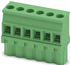
插拔式连接器，额定横截面: 2.5 mm<sup>2</sup>，颜色: 绿色，额定电流: 12 A，额定电压 (III/2): 320 V，触点表面: 锡，触点类型: 孔式连接器，电位数: 6，行数: 1，位数: 6，连接量: 6，产品系列: MVSTBW 2,5/..-ST，针距: 5.08 mm，接线方式: 带压片的螺钉连接，螺钉头规格: L 开槽，导线/PCB连接方向: -90°，锁扣: - 锁扣，插拔系统: COMBICON MSTB 2,5，互锁: 不带，安装: 不带，包装类型: 纸箱包装
