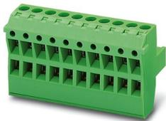
插拔式连接器，额定横截面: 2.5 mm<sup>2</sup>，颜色: 绿色，额定电流: 12 A，额定电压 (III/2): 320 V，触点表面: 锡，触点类型: 孔式连接器，电位数: 6，行数: 1，位数: 6，连接量: 12，产品系列: TMSTBP 2,5/..-ST，针距: 5.08 mm，接线方式: 带压片的螺钉连接，螺钉头规格: L 开槽，导线/PCB连接方向: 0°，锁扣: - 锁扣，插拔系统: COMBICON MSTB 2,5，互锁: 不带，安装: 不带，包装类型: 纸箱包装，插头用于在模块与模块之间的总线连接。
