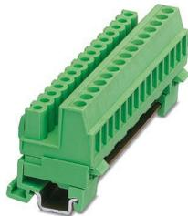
DIN导轨连接器，额定横截面: 2.5 mm<sup>2</sup>，颜色: 绿色，额定电流: 12 A，额定电压(III/2): 320 V，触点表面: 锡，触点类型: 孔式连接器，电位数: 6，行数: 1，位数: 6，连接量: 6，产品系列: MSTBVK 2,5/-ST，针距: 5.08 mm，接线方式: 带压片的螺钉连接，螺钉头规格: L 开槽，安装: 安装导轨，导线/PCB连接方向: 0°，插拔系统: COMBICON MSTB 2,5，互锁: 不带，安装: 不带，包装类型: 纸箱包装
