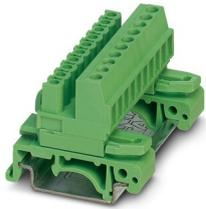
DIN导轨连接器，额定横截面: 2.5 mm<sup>2</sup>，颜色: 绿色，额定电流: 12 A，额定电压 (III/2): 320 V，触点表面: 锡，触点类型: 孔式连接器，电位数: 6，行数: 1，位数: 6，连接量: 6，产品系列: UMSTBVK 2,5/..-ST，针距: 5.08 mm，接线方式: 带压片的螺钉连接，螺钉头规格: L 开槽，安装: 安装导轨，导线/PCB连接方向: 0°，插拔系统: COMBICON MSTB 2,5，互锁: 不带，安装: 不带，包装类型: 纸箱包装
