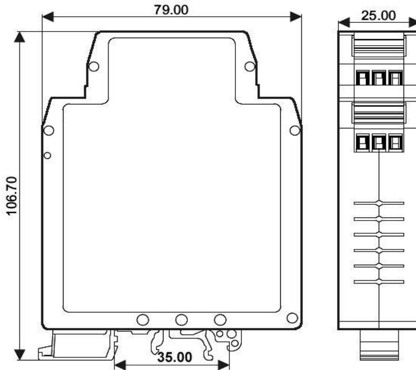
可以安装在标准 DIN35 导轨上
